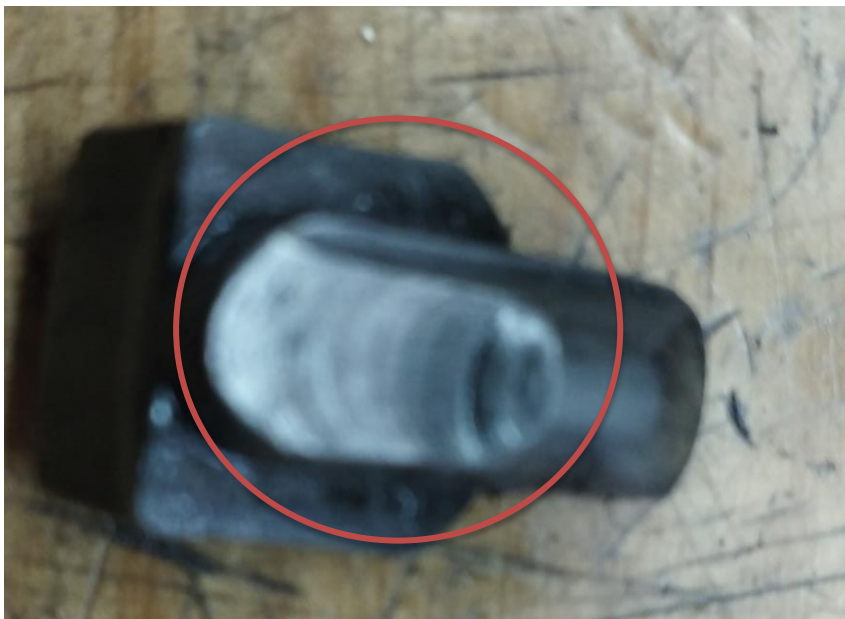
Obr.2 Poškodenie upínacieho valčka
