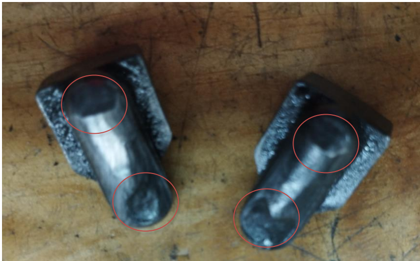
Obr.2 Poškodenie upínacích valčekov
