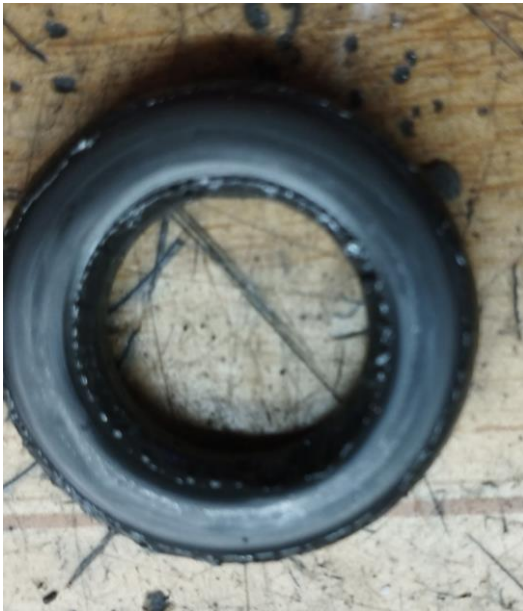
Obr.4 Poškodenie tlmiacej podložky
